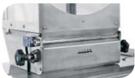
Zentral einstellbarer Einlauf ermöglicht die exakte Positionierung des Teigstückes
