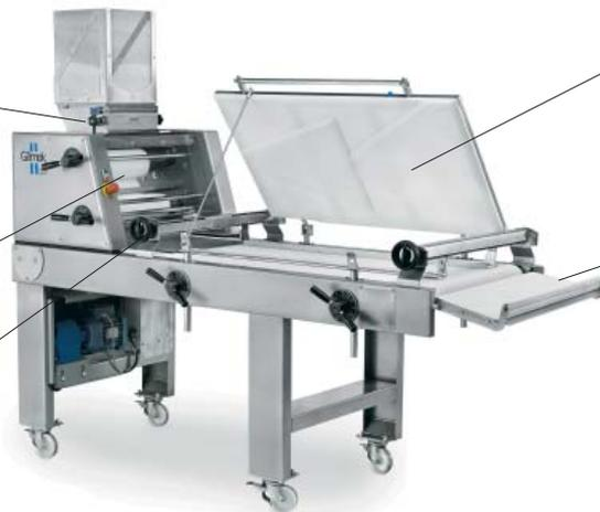
Druckbrett 650 x 1100 mm, kann zum Reinigen aufgeklappt werden
